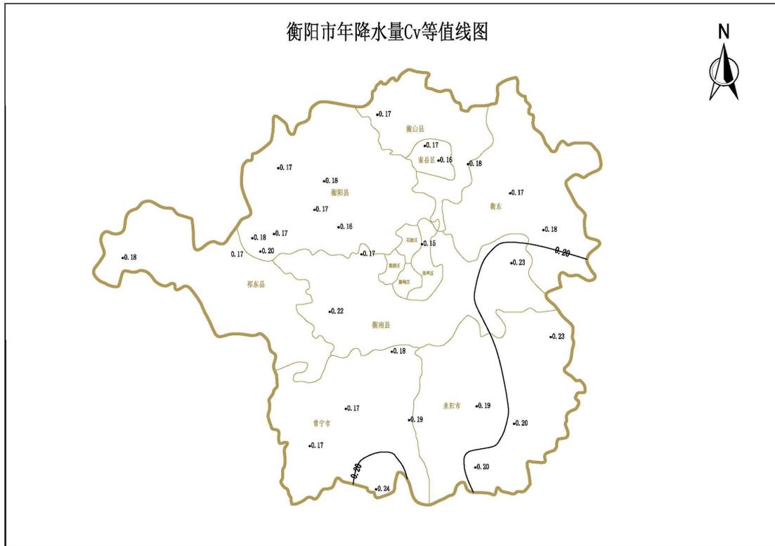
图 2.1.3.2-1 衡阳市降水量 Cv 等值线图
