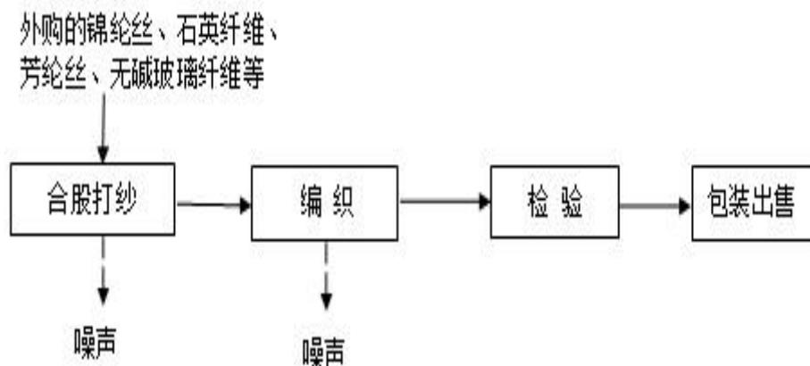
图 2-4 技改项目运营期生产工艺流程图
