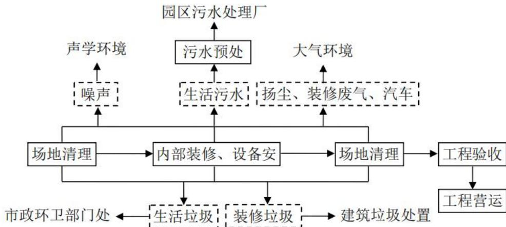
图 2-1 施工期工艺流程及产污环节图
