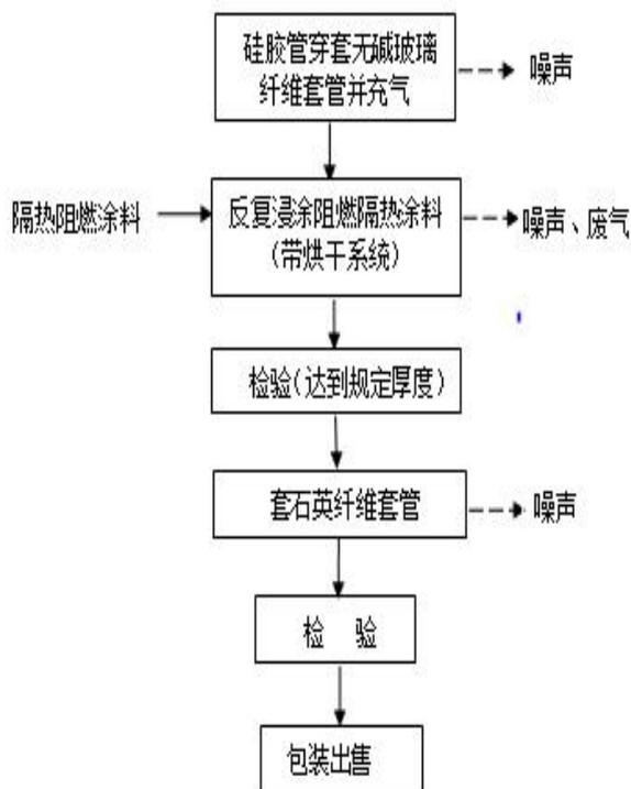
图 2-5 技改项目运营期生产工艺流程图
