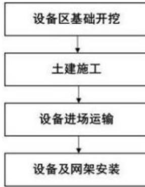
图 2.5-6 变电站扩建间隔工程施工工艺流程图
