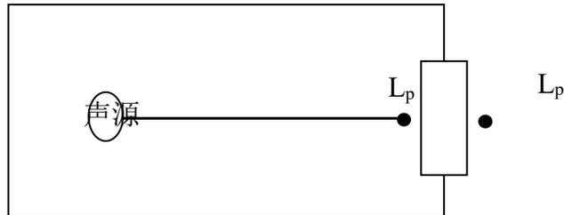
图 7.3-1 室内声源等效为室外声源图例
