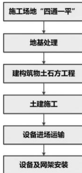
图2-1 变电站工程施工工艺流程
