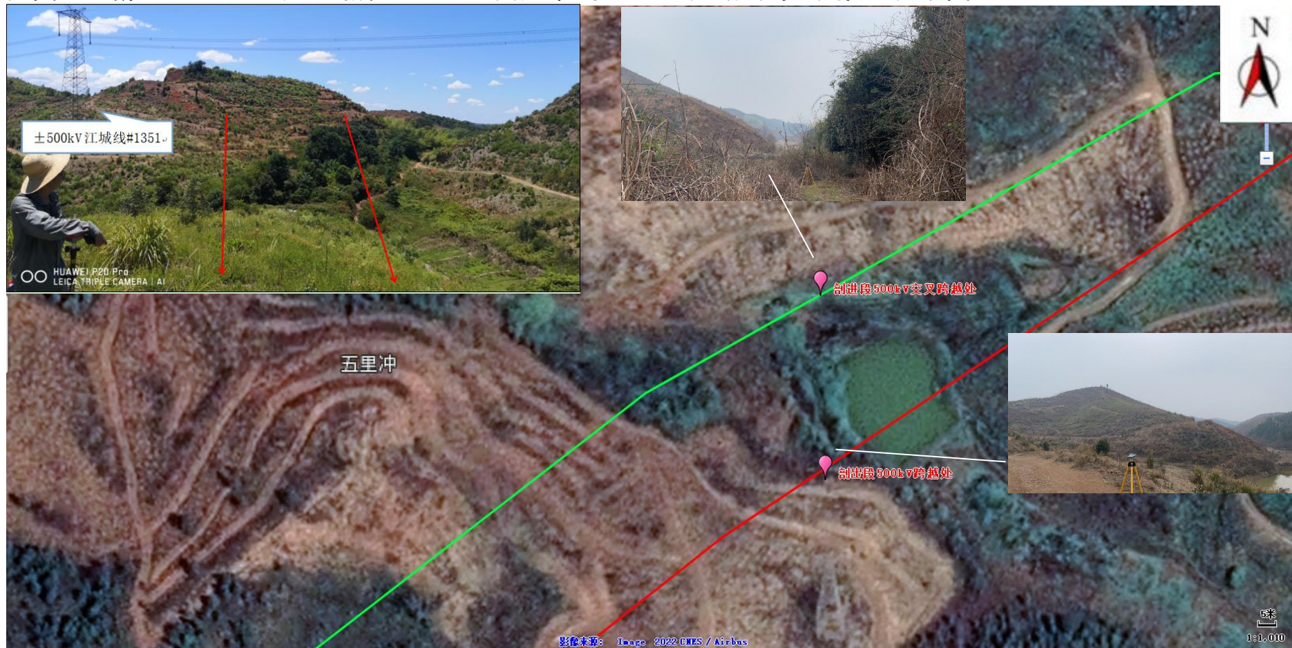
附图五：新建烟洲~坦岭π入荫田 110kV 线路工程与 500kV 江城线跨越处位置关系图
